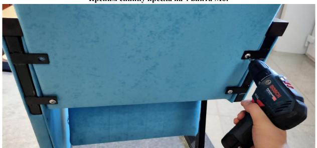
Протягиваем винты крепления перемычки:
