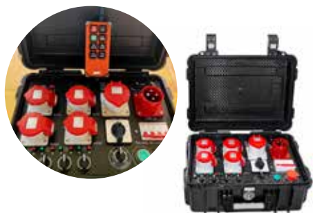
Пульт управления электрической цепной лебедкой
